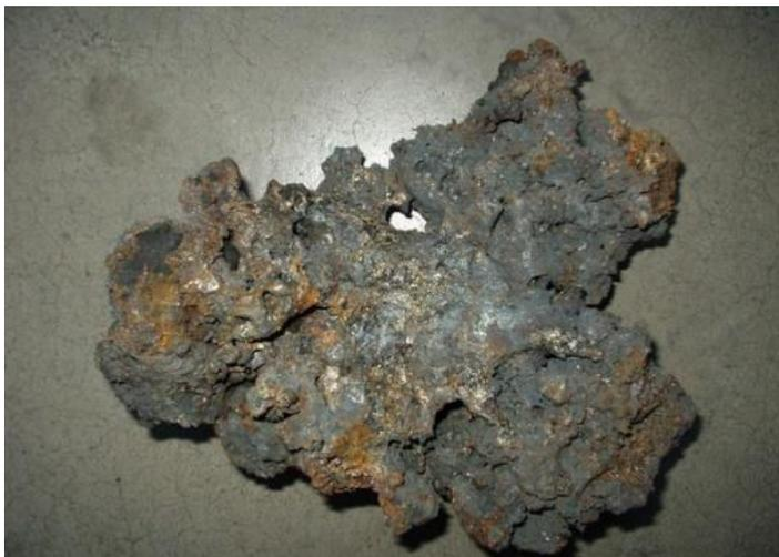
Das nebenstehende Bild zeigt ein solches Teilstück, wie es als Rohmaterial angeliefert wird. Man kann hier noch gut die Spuren erkennen, die beim Rennern und Verhütten des Eisensandes entstanden sind. Wie oben geschrieben handelt es sich ja um ein Stück von der Seite des Schmelzblockes.<sup>21</sup>
